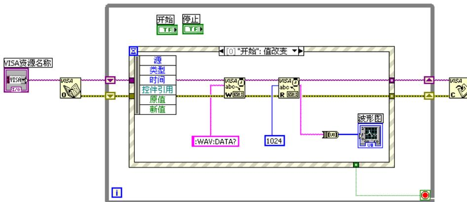
11. 调整前面板的样式，点击“捕捉波形”后可得到如下界面（示波器已正确连接）：
