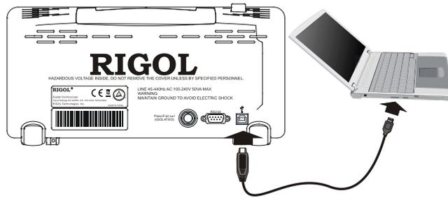
示波器与 PC 正确连接后，接通仪器电源，此时 PC 上将弹出“硬件更新向导”对话框，请按照向导的提示安装“Rigol USB Test and Measurement Device”（使用 RIGOL USB 驱动时）或“USB Test and Measurement Device”（使用 VISA 时）。
