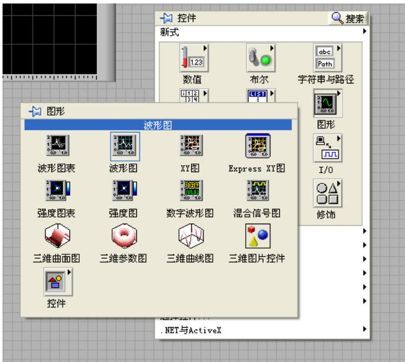
6. 打开 LabVIEW 程序框图，点击右键，在“编程”→“字符串”→“字符串/数组/路径转换”中选择一个“字符串至字节数组字符转换”函数，用其将刚刚创建的波形图与“VISA 读取”函数中的“读取缓冲区”连接起来。
