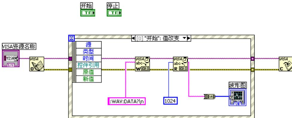
9. 为程序增加一个 While 循环，并增添一个“布尔”→“真常量”将“程序停止”按钮的事件指向 While 退出：
