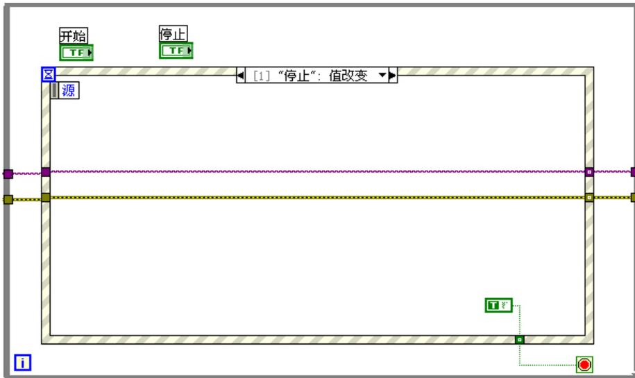
10. 将 While 循环上的 VISA 资源名输入和错误输入更改成“移位寄存器”，程序的制作就此结束：
