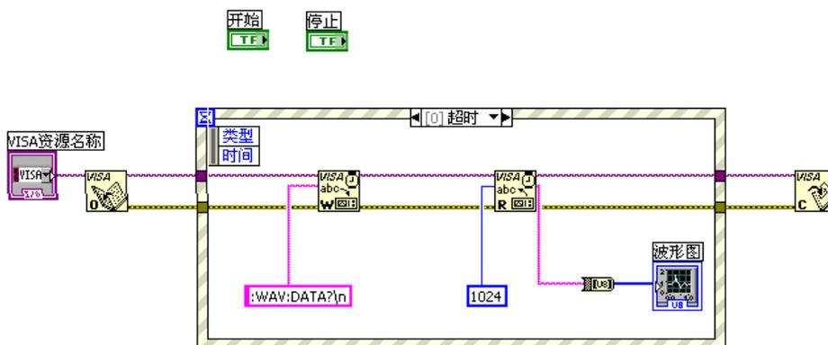
8. 在“选择器标签”上点击右键，选择“编辑事件分支”或者“添加事件分支”，分别为按钮添加事件，“开始”进行波形捕捉，“停止”退出程序：
