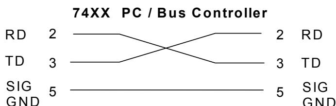
其通信埠須符合以下的結構：9600 baud、8 data bits、1 stop bit、no polarity 等。這個介面不支援 XON/XOFF 的 protocol 和任何硬體方式的 Handshaking。控制器 (Controller) 的架構必須具有排除 Handshaking Lines DTR (PIN 4)、DSR (PIN 6) 及 RTS (PIN 9) 的功能。如果這通信埠不能經由軟體方式排除 Handshaking Lines 時，Handshaking Lines 則應分兩個不同組群，分別跳接在一起。PIN 4 和 6、PIN 7 和 8 必須在控制器電纜的末端接合在一起。
