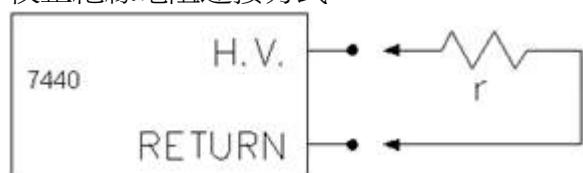
校正交流接地阻抗電壓(電流)連接方式
