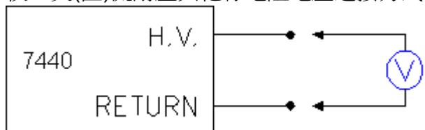
校正交(直)流電流連接方式
