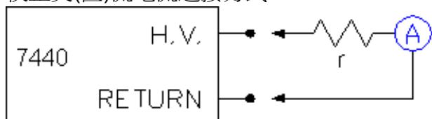
校正絕緣電阻連接方式
