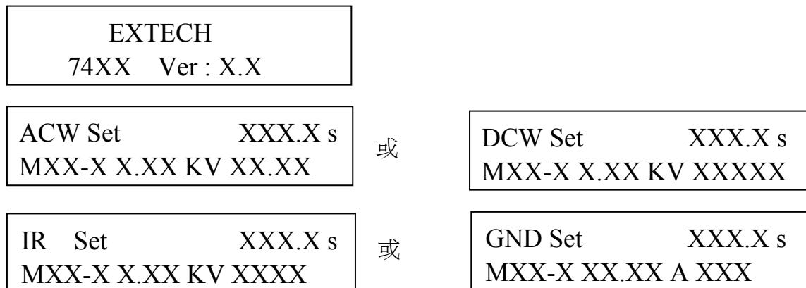
註明：如果記憶組 **MXX-X\_** 時，表示該步驟測試完成後，會自動連接到下一個測試步驟。
